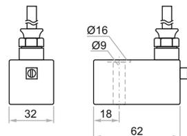
Para válvulas con un diámetro de armadura (Martillo) de 9 mm
