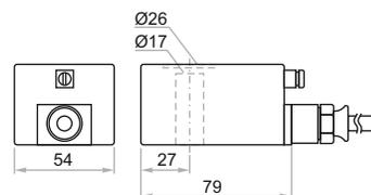
Para válvulas con un diámetro de armadura (Martillo) de 17 mm
