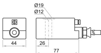
Para válvulas con un diámetro de armadura (Martillo) de 12 mm
